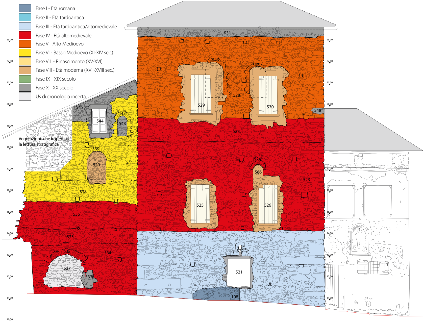
Figura 5 Prospetto esterno W Analisi stratigrafica
