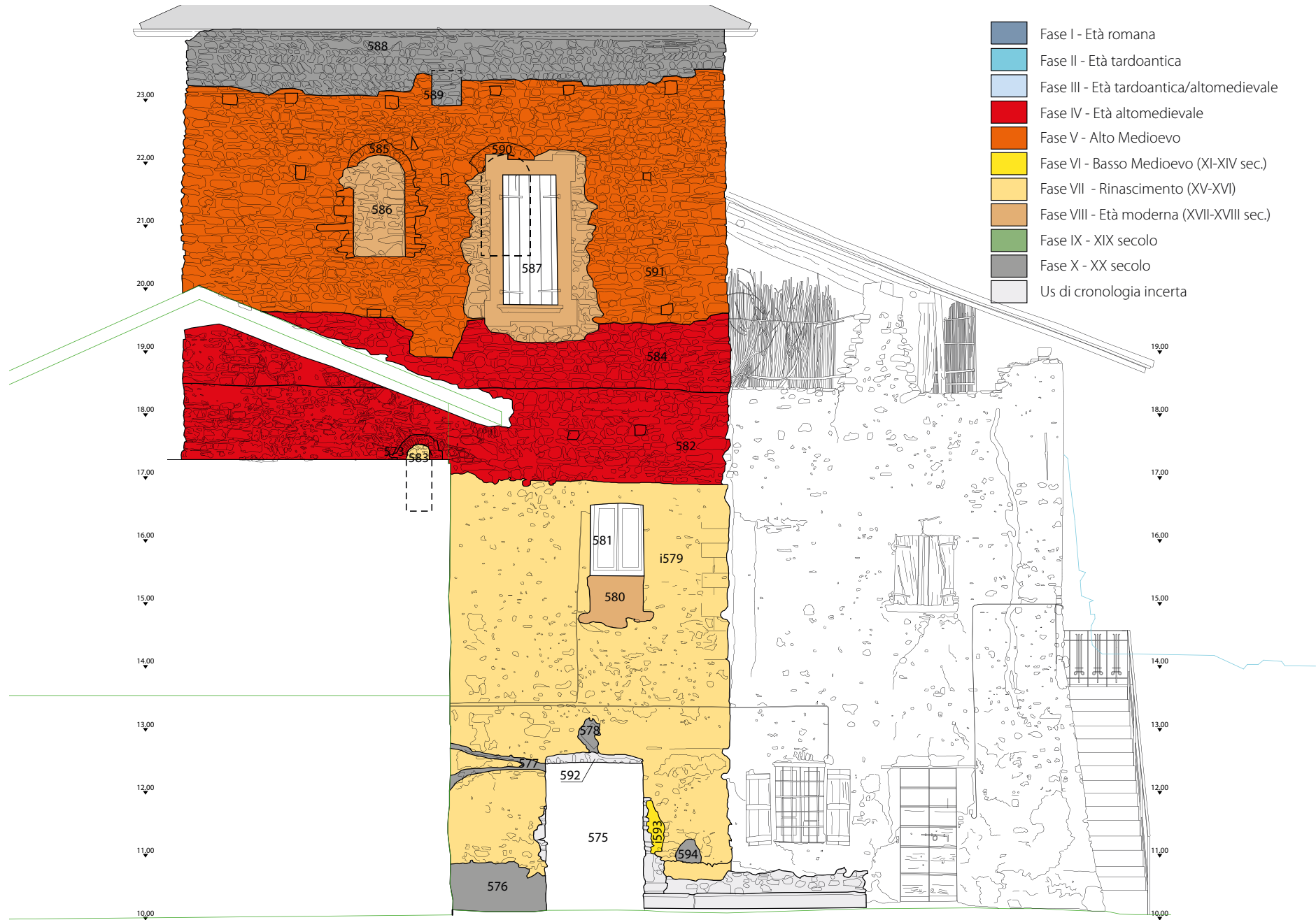
Figura 7 Prospetto esterno E - Analisi stratigrafica
