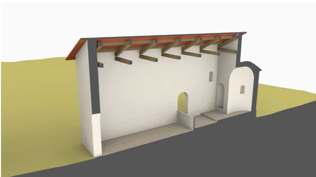
Figura 79 Ricostruzione grafica della chiesa altomedievale (sezione longitudinale)
